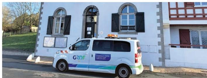
2- Le véhicule aspire l'air ambiant en « reniflant » la chaussée grâce à des capteurs situés à l'avant du véhicule, au plus près du sol.
